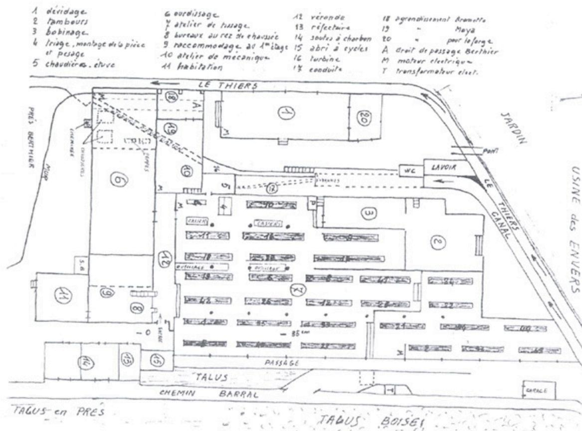
Plan des installations de l'ancienne usine de tulle avant le démantèlement des ateliers de tissage
