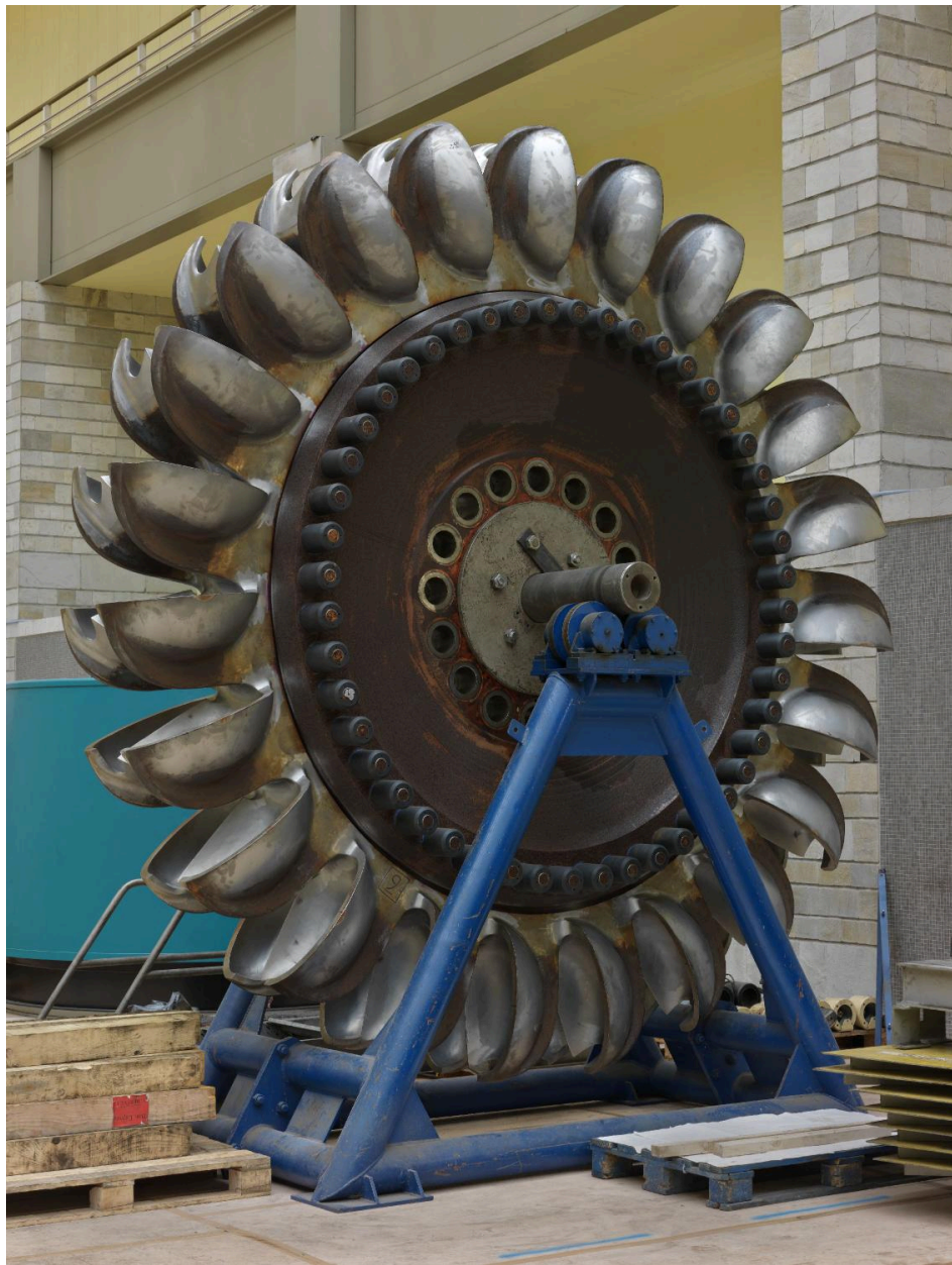
Roue Pelton (à augets) 23 tonnes, 4 mètres de diamètre
