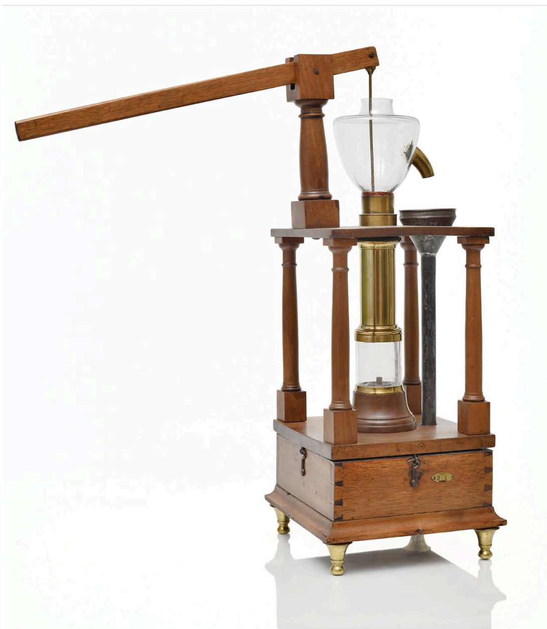
Pompe aspirante et foulante, vue 2
