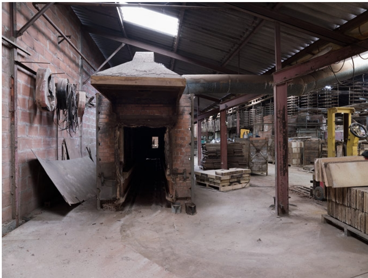
Four ou train de cuisson de 33 mètres de long
