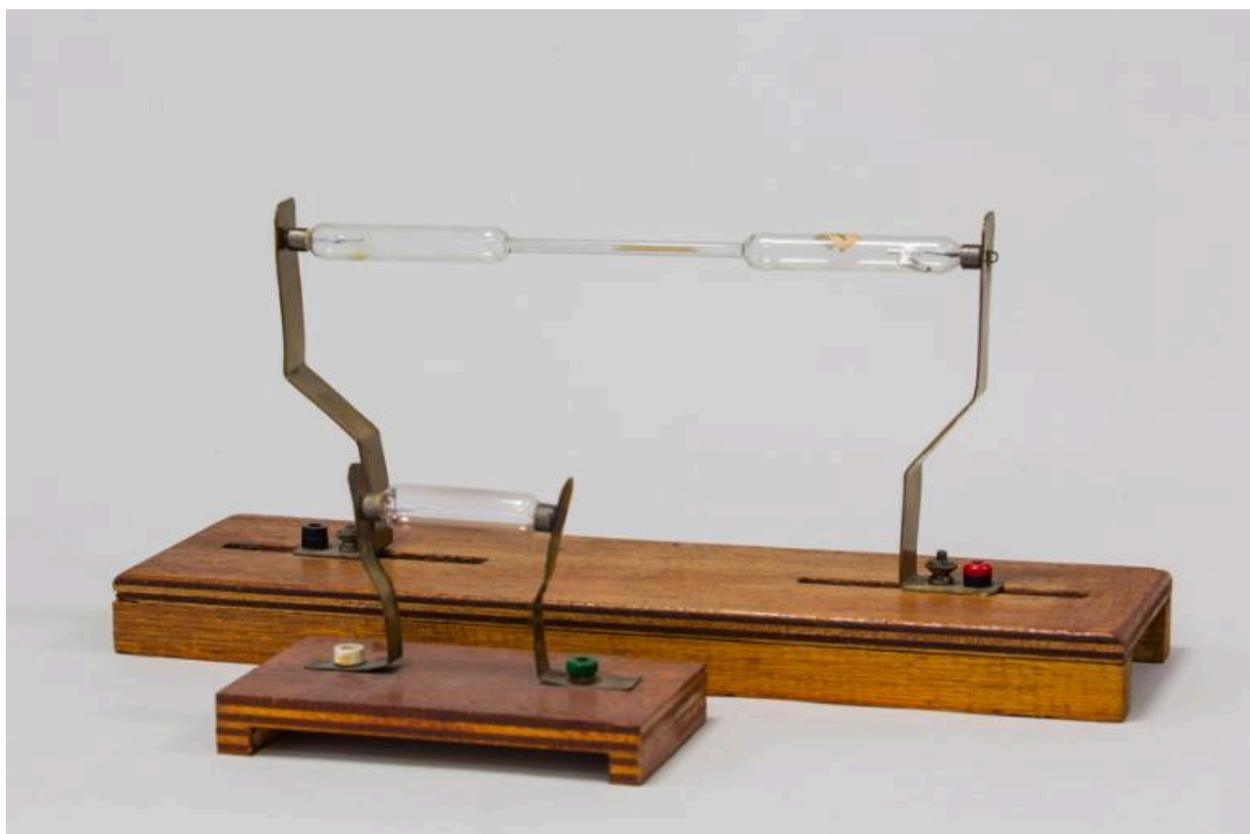
Cylindres à hydrogène ou tubes de Geissler (ou de Plücker)
