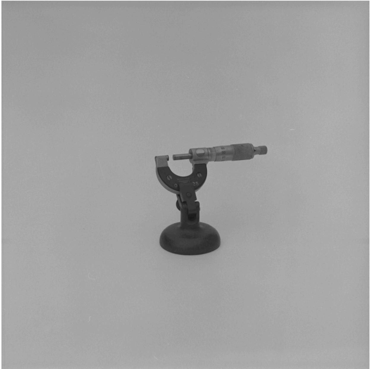
Instrument de mesure : appareil à mesurer l'épaisseur du diamant (palmer).
