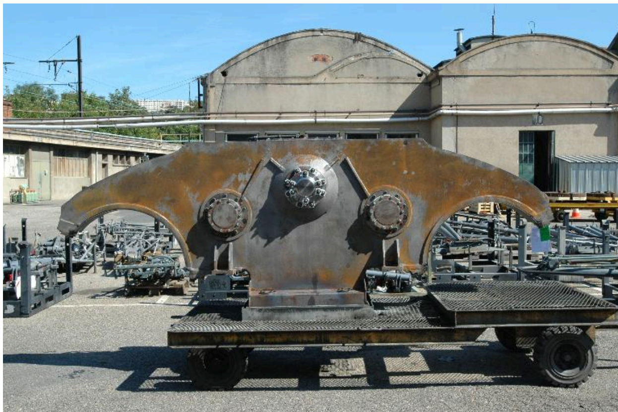
Partie de carter servant à protéger la transmission du moteur électrique à l'essieu
