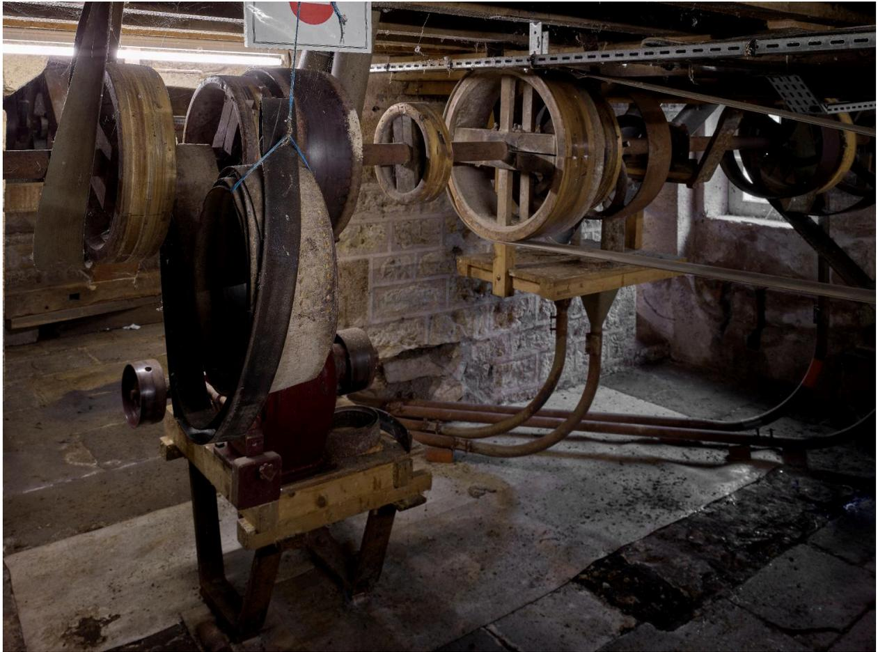
Sous-sol : Vue générale des éléments d'engrenages et de transmission.
