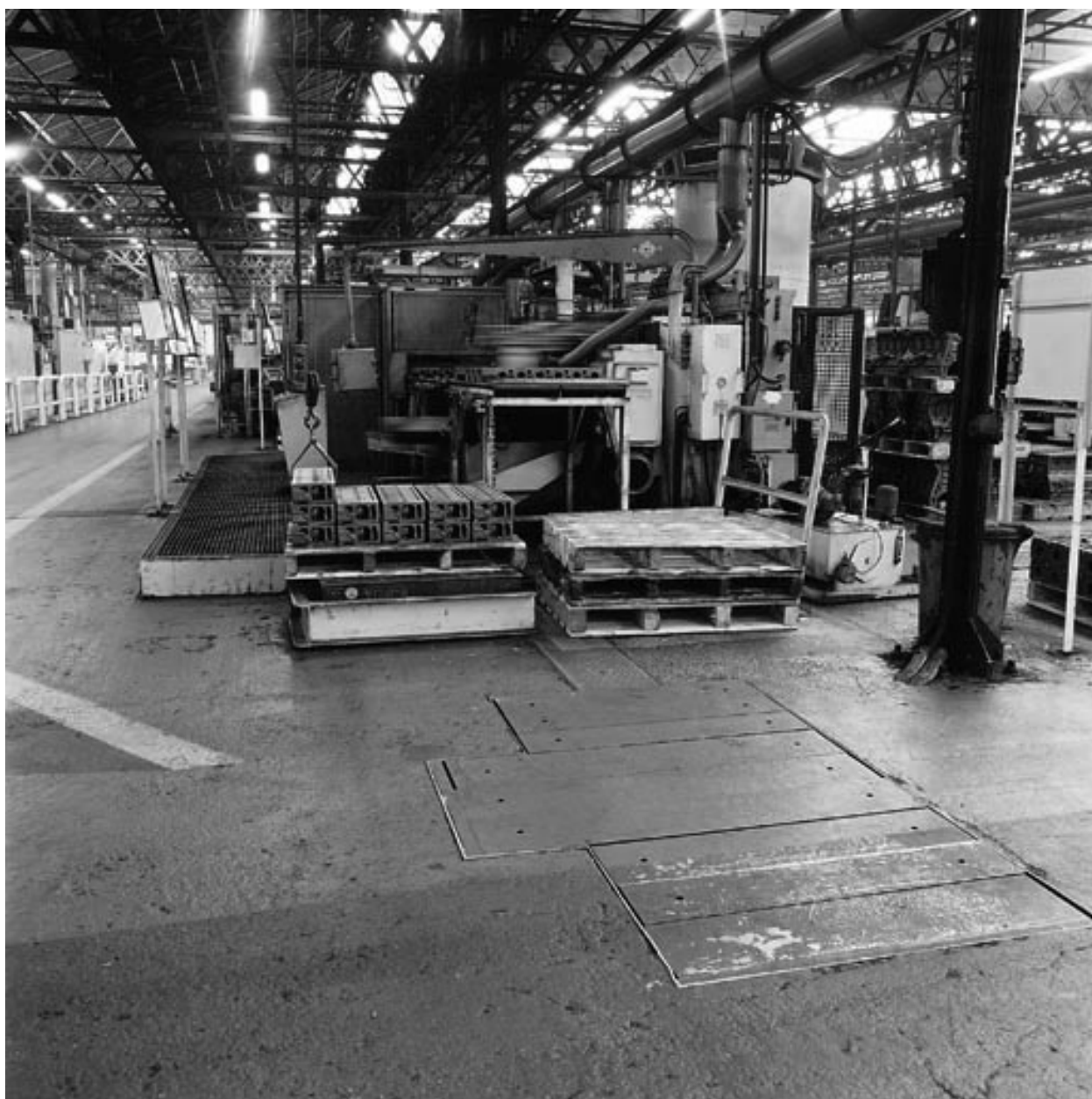
Usine moteur : ligne usinage culasse engagement des culasses qui viennent de la fonderie.
