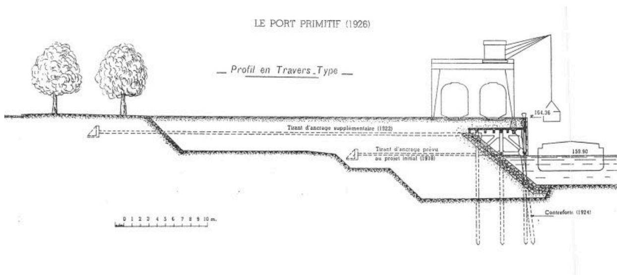
Le port primitif (1926). Profil en travers type. Dans Le port Rimbaud à Lyon, 1956. P. 73
