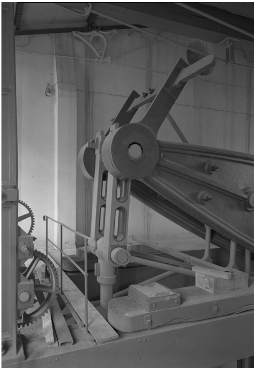
Pompe de Cornouailles : détail balancier
